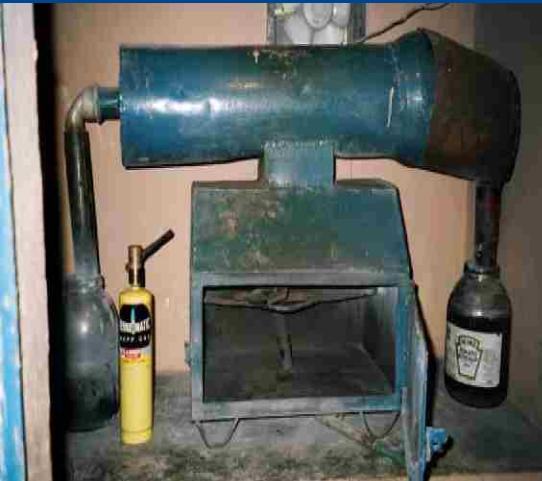
Gunakan *retort* dan cerobong asap yang dilengkapi saringan udara untuk menangkap raksa
